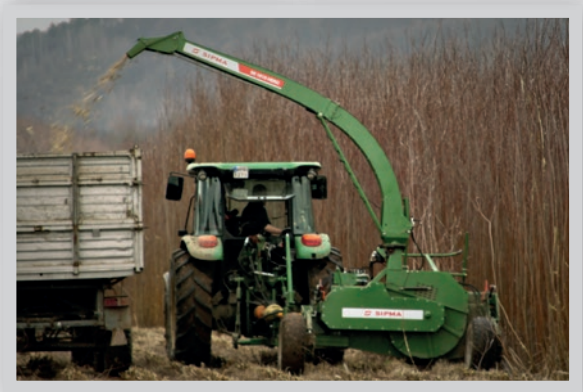
SIECZKARNIA SIPMA DO ROŚLIN ENERGETYCZNYCH PODCZAS PRACY
