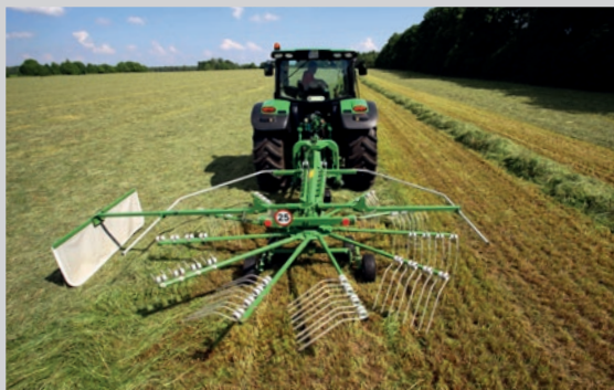
ZGRABIANIE POKOSU ZA POMOCĄ ZGRABIARKI SIPMA ZK 450 WIR
