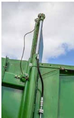
Widoczność do środka jest dobra. Otwarcie zasuw jest wskazywane na skali, ale linka nie jest naprężana sprężyną.
