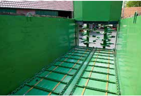
Przeñośnik podłogowy niezawodnie przesuwają obornik do adaptera. Podłoga i ściany boczne są idealnie gładkie.
