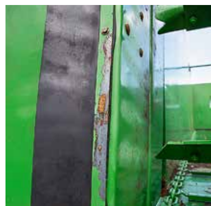
Powłoka lakiernicza nie spełnia jeszcze standardów czystości światłowych producentów.
