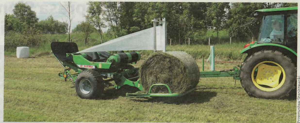
W owijarce Sipma OS 7650 Gaja najazd na belę odbywa się zgodnie z kierunkiem zbioru prasy tzn. wzdłuż pola. Po podjechaniu do beli, następuje jej uchwycenie i załadunek na stół, który składa się z dwóch walców i czterech pasów. Stół może osiągnąć maksymalnie 32 obr./min
