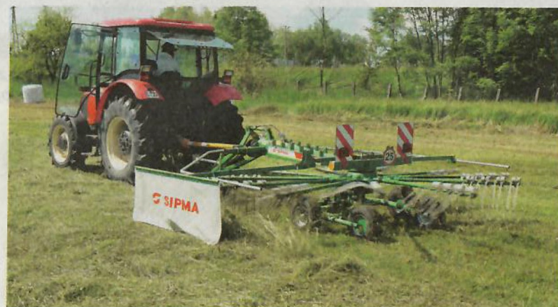
Zgrabiarka jednowirnikowa Sipma ZK 455 Wir może pracować z prędkością 10 km/h
