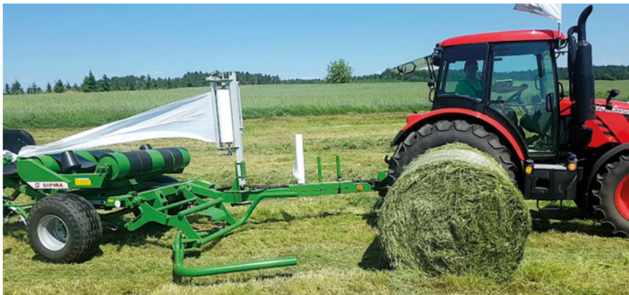
Na stole najnowszej owijarki OS 7650 GAJA można owijać bele o masie do 1,2 t.
