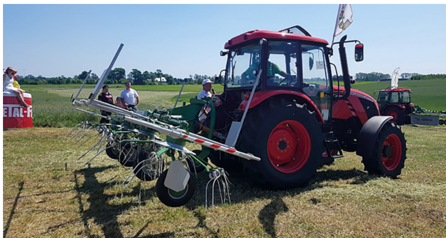
4-wirnikowy przetrząsacz PT 520 SALSA pracuje na szerokości roboczej 5,2 m.
