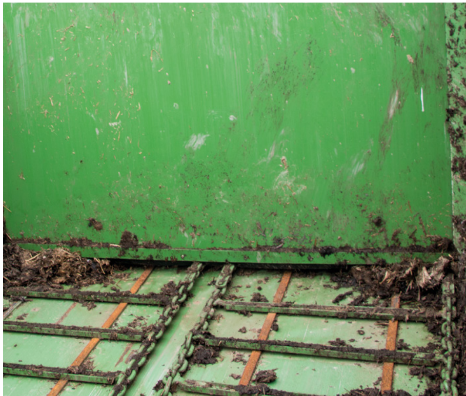
Na dnie skrzyni ładunkowej pracuje podwójny przenośnik łańcuchowo-listwowy.
