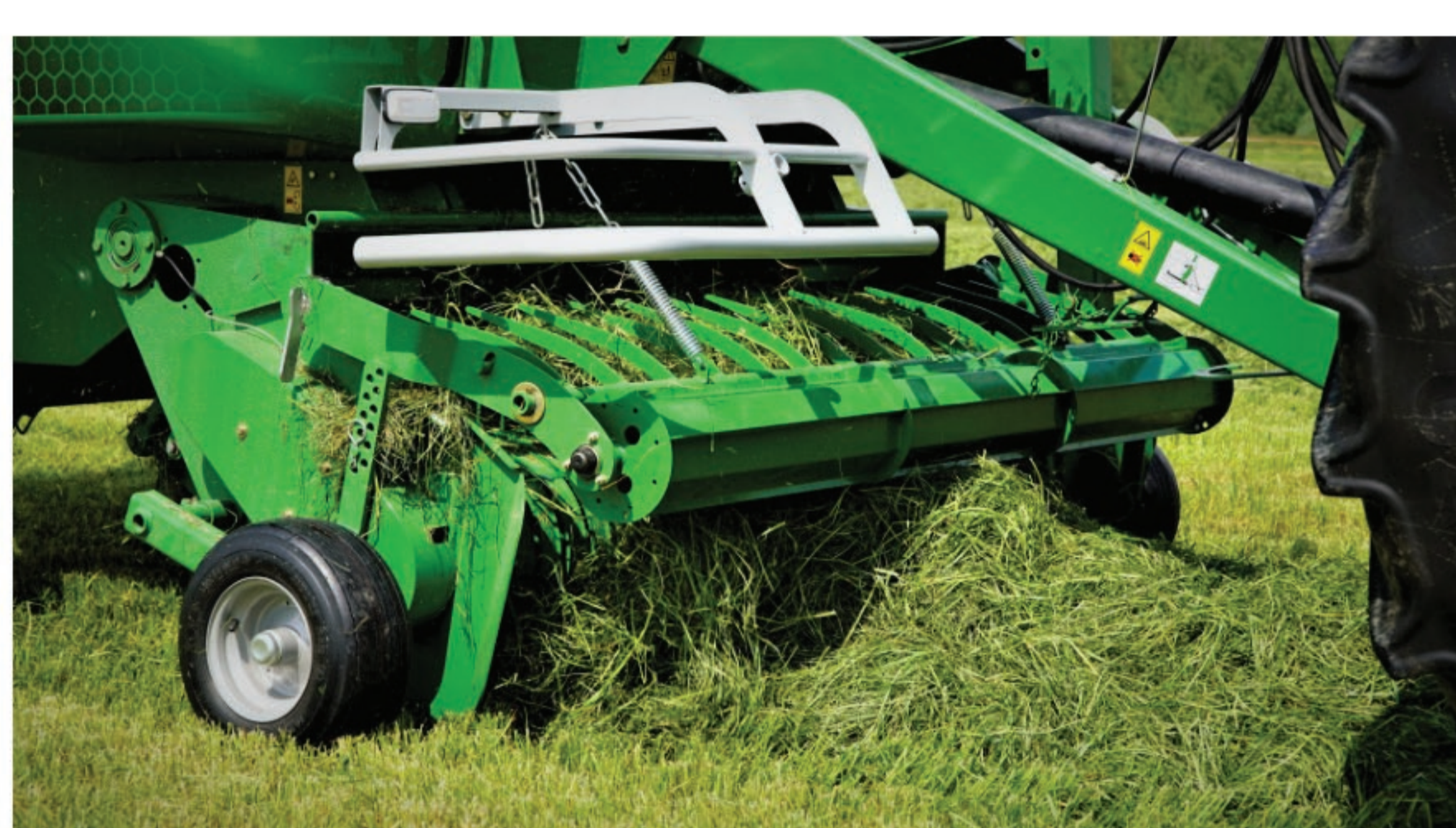
Wysokowydajny zespół podająco-rozdrabniający Supry z systemem uchyłnej podłogi, wyposażony jest w 15 noży, fot. K.Pawłowski
