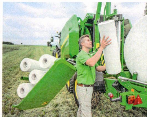
Der Rollenwechsel ist in der Regel innerhalb weniger Minuten erledigt. Der Vorrat unterscheidet sich von Maschine zu Maschine.
