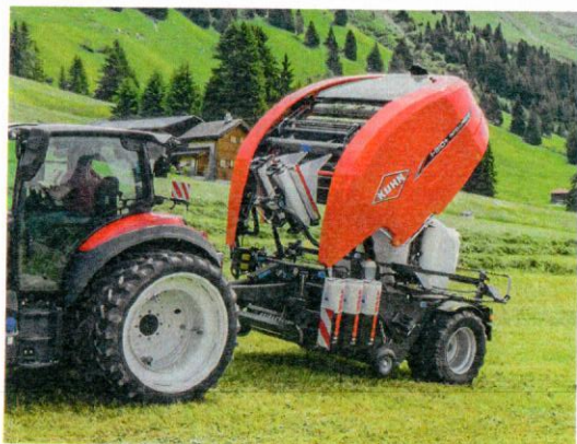
Das Folienbindungssystem von Kuhn setzt zwei standardmäßige Stretchfolienrollen ein. Es wird keine breite Spezialfolie benötigt.
