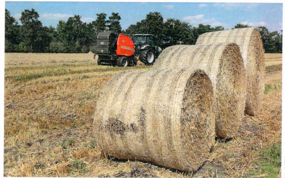
Die variable Rundballenpresse von Vicon ermöglicht Ballen mit einem Durchmesser von 0,60 bis 2,00 m.
