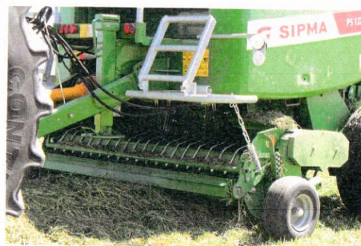
Wie bei Ladewagen teilt sich auch bei Rundballenpressen der Markt zwischen gesteuerten und ungesteuerten Pick-Ups auf.
