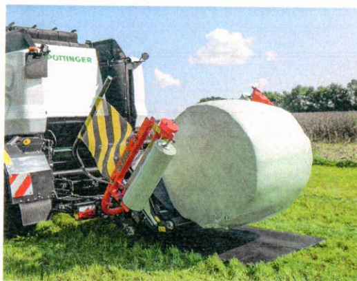
Um den Ballen bei der Ablage vor Beschädigungen zu schützen, landet er bei der Pöttinger Impress auf einem Tuch.
