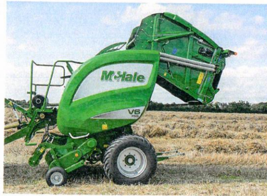
Bei der McHale V6750 kann der Fahrer den Ballendurchmesser zwischen 0,6 und 1,68 m einstellen.
