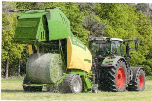
Krone bietet als einziger Hersteller die semivariable Presskammer an. Sie arbeitet mit Stabgurten, der Ballendurchmesser ist variabel.
