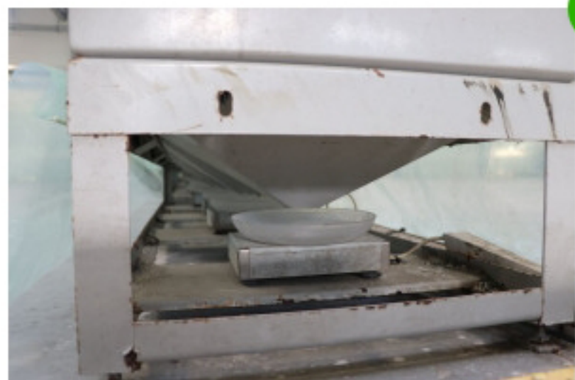
Aparatura pomiarowa składa się z szeregu wag rozmieszczonych w poprzek hali fot. Tomasz Kuchta
